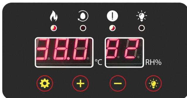
Над экранами дисплея слева направо находятся световые индикаторы: функции подогрева, поворота яиц, сигнализации и светодиодного овоскопа.
