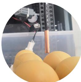
Убедитесь, что датчик температуры не касается яиц, лотков, стенок или греющего кабеля инкубатора. Нормальное расположение датчика — на уровне верхнего края яиц, не касаясь их, чтобы на него не попадал потока воздуха вентилятора/вентиляторов.
