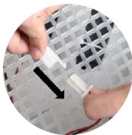
Соедините разъем механизма поворота с панелью управления и аналогичным образом подключите USB-увлажнитель.
